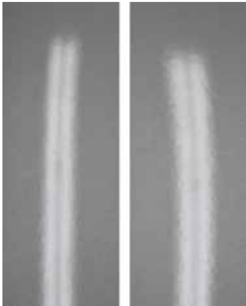
Op deze foto ziet u twee panelen. Het paneel links heeft een Ultragal®-bekleding. Let op de reflectie van het tl-licht. Het paneel rechts is behandeld met Extragal®: dat er hier golving is, blijkt uit de vervormde reflectie.
