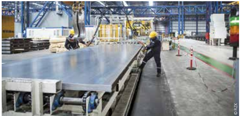
Het bedrijf kan platen in breedtes tot 4000 mm verwerken, wat ideaal is voor de scheeps- of olie- en gastoeepassingen van lokale klanten.
