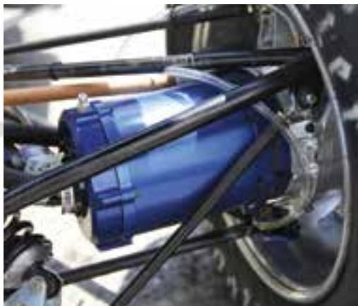
Elk wiel wordt aangedreven door een onafhankelijke elektromotor met iCARE® Save.
